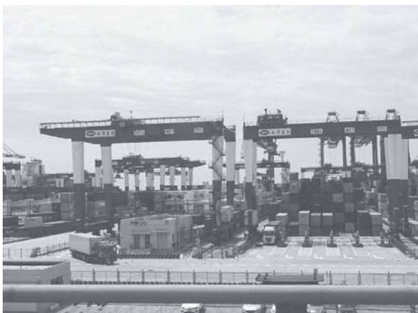
無人自動化システムとしてZPMCが製作した荷役機器は、ガントリークレーン10機、オートレール式トランスファークレーン40機、無人搬
